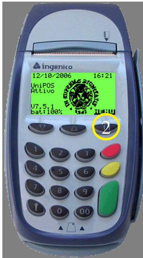
1. Appoggiare il **POS** ad una base connessa con l'alimentazione elettrica e la linea telefonica.
